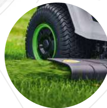
MAAIDEK VAN 107 CM 3-IN-1-FUNCTIE: ZIJ-UITWORP, MULCHEN EN OPVANGEN
